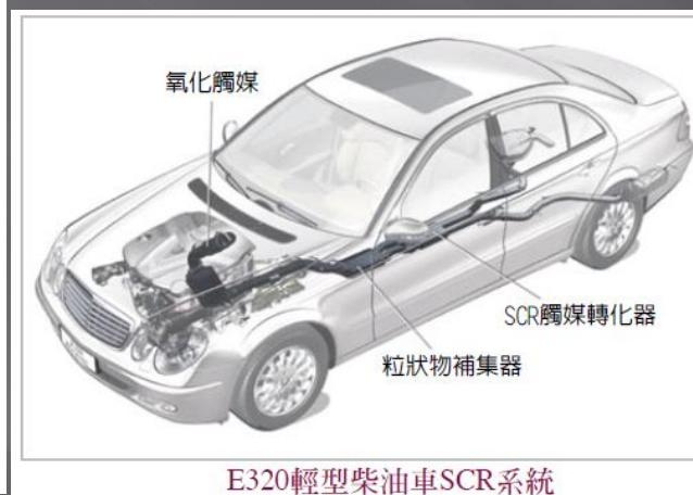
E320輕型柴油車SCR系統
