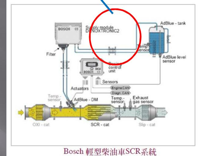
Bosch 輕型柴油車SCR系統
